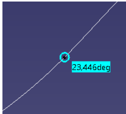
Figura 2.238 Indicación de la discontinuidad G3 con la opción de Quick display mode activada.
