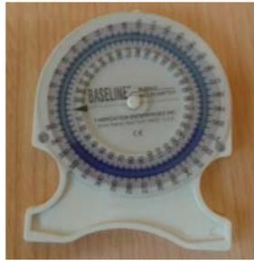
Figura 10. Inclinómetro (Fuente: elaboración propia).
