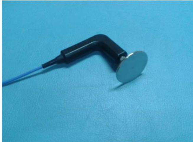
Imagen 8. Cabezal resistivo (Fuente: elaboración propia).
