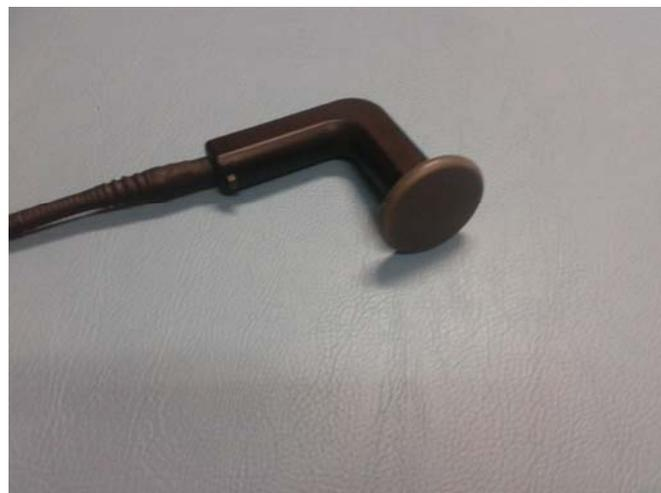
Imagen 6. Cabezal capacitivo (Fuente elaboración propia).
