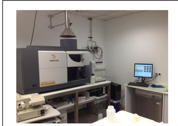
**Figura 18:** Equipo ICP óptico, Varian 710-ES, disponible en Socamex
