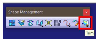
*Figura 218. Localización de la herramienta Trim de ICEM Shape Design*
