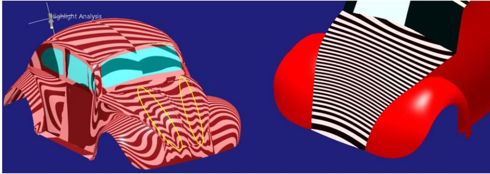
Figura 257. Irregularidades superficiales del capó (izquierda) y capó con buen acabado (derecha)
