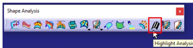
*Figura 104. Localización de la herramienta Highlight Analysis en ICEM Shape Design*
