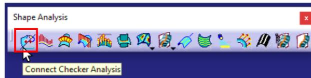
Figura 111. Localización de la herramienta *Connect Checker Analysis* en *ICEM Shape Design*
