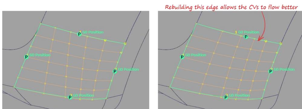
Figura 91. Arreglo de la malla de puntos de control con cuatro aristas preexistentes [1]
