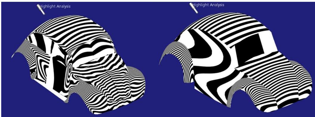
Figura 258. Análisis de reflejos. Modelo internet (izquierda). Modelo previo creado (derecha)
