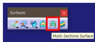
Figura 206. Localización de la herramienta *Multi-Sections Surface* de *Generative Shape Design*
