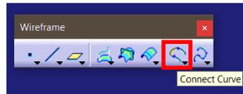
Figura 239. Localización del comando Connect Curve de Generative Shape Design
