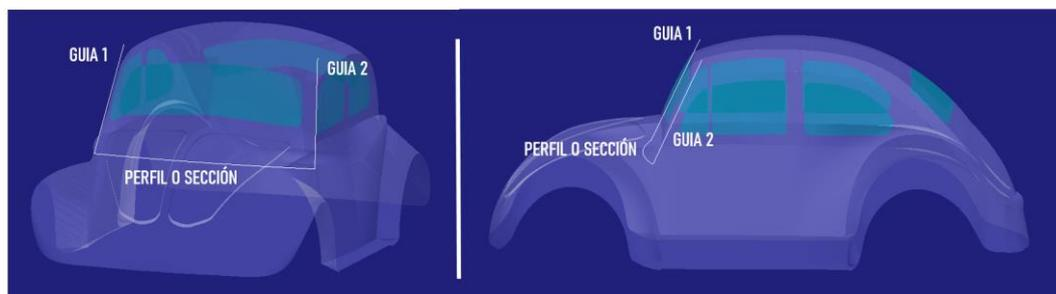
Figura 200. Guías y perfil que define la superficie del parabrisas
