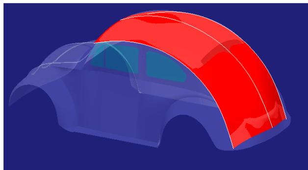
Figura 168. Modelado del techo a partir de curvas que definen el contorno lateral
