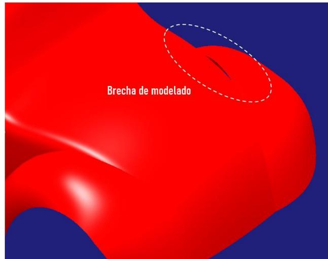
*Figura 306. Brecha de modelado generada entre el capó y el guardabarros delantero*
