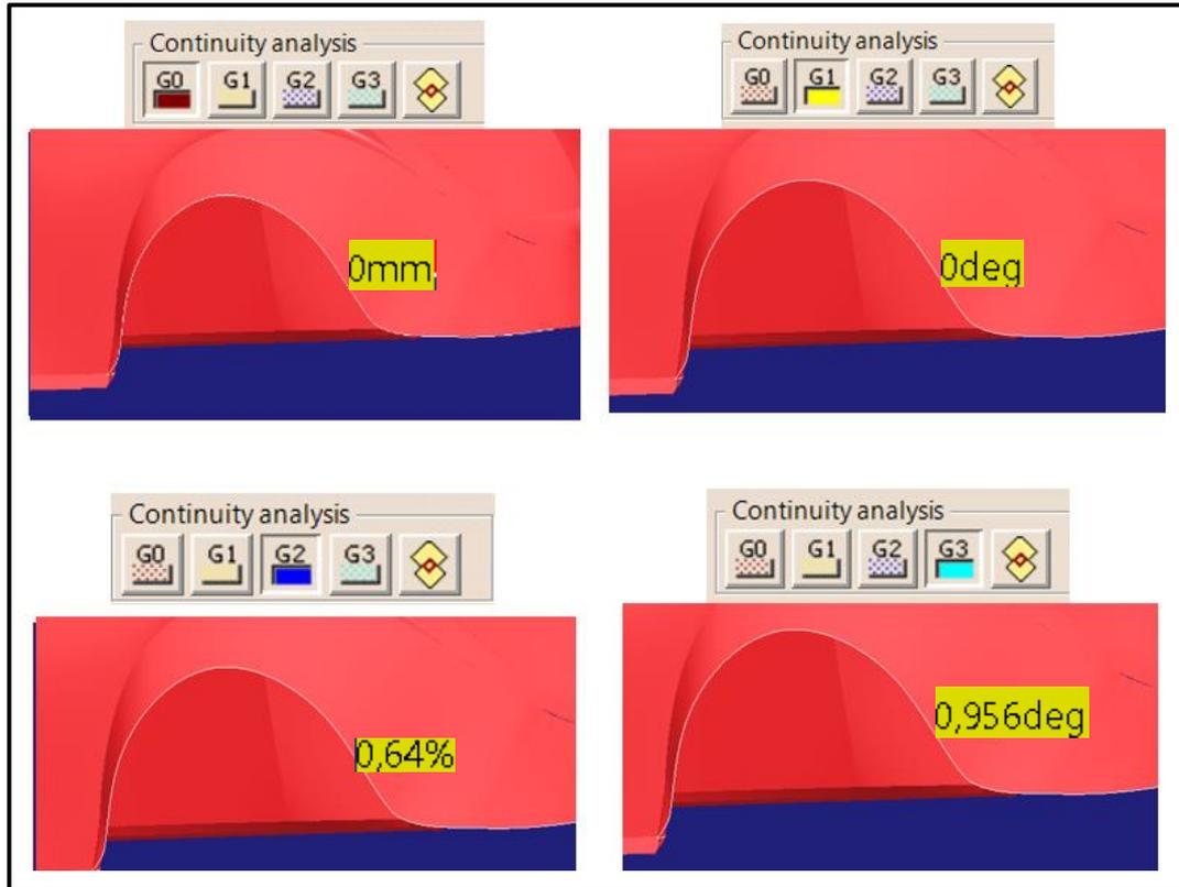
Figura 116. Resultado del análisis de conexión entre curvas
