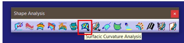
Figura 123. Localización de la herramienta *Surfacic Curvature Analysis* de ICEM Shape Design
