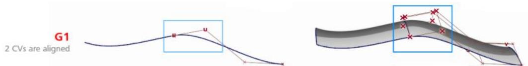
Figura 24. Puntos de control en continuidad G1 [1]
