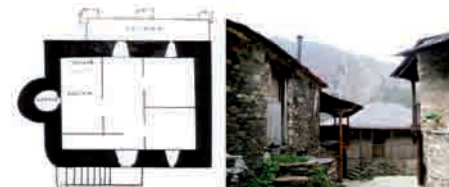
Planta vivienda serrana. (Fuente: J. M. LUENGO). De planta rectangular, conserva todavía la característica castreña de tener uno o varios ángulos externos en forma redondeada. Consta de dos plantas, el inferior dedicado a cuadras y la superior para vivienda.
