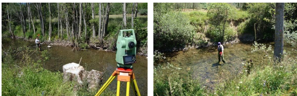
Figura 14. Levantamiento topográfico (izq.) y medición de velocidad (dcha.) en el tramo.
