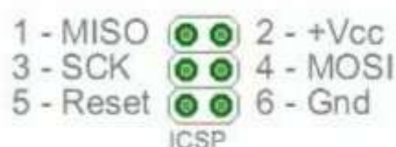
Figura 35. Esquema de conexiones para ICSP Arduino. [32]
