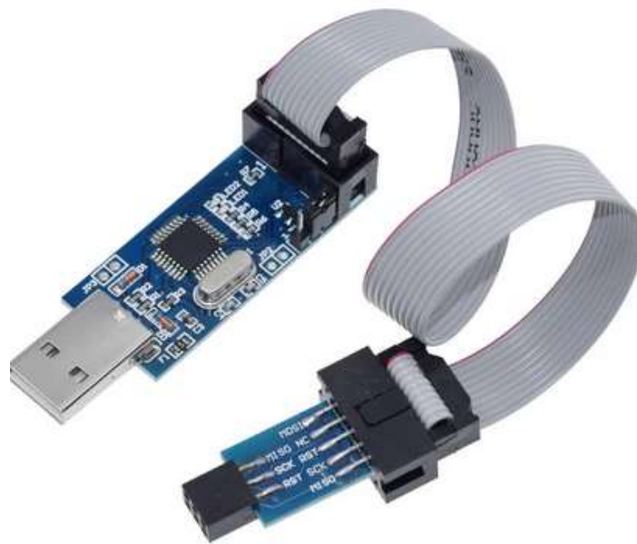
Figura 45. Programador USBasp empleado en la instalación del bootloader
