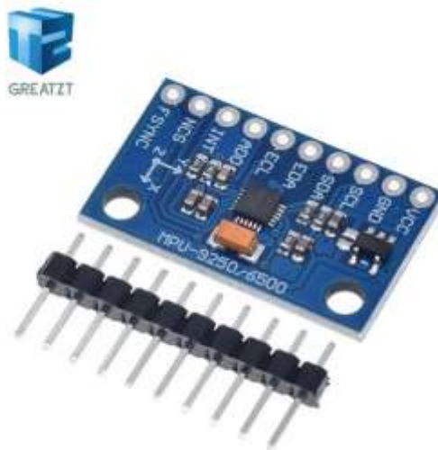
Figura 6. Conjunto de sensores MEMS MPU-9250 vista preliminar.[14]
