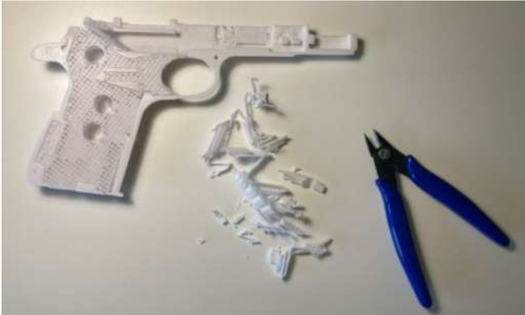
Figura 67. Visualización del proceso de retirada de soportes.
