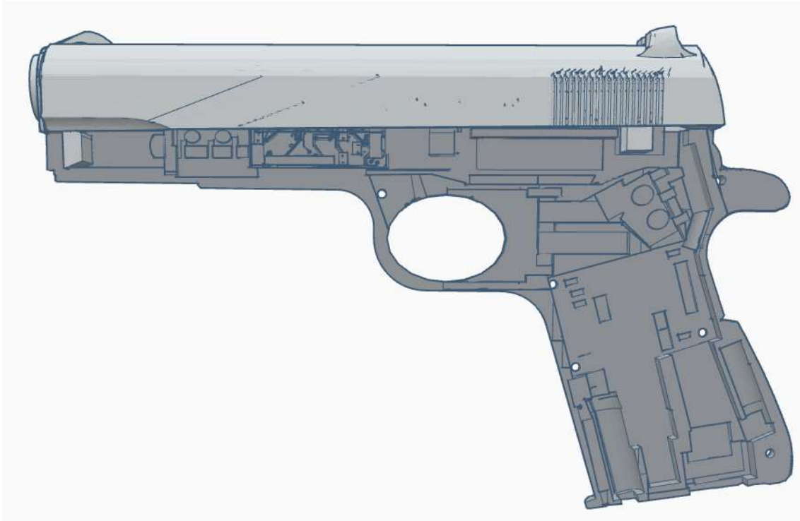
Figura 60. Sección de la base con corredera acoplada.
