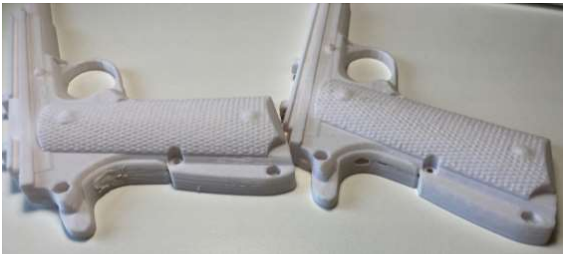
Figura 68. Comparación de piezas tras la aplicación de masilla.
