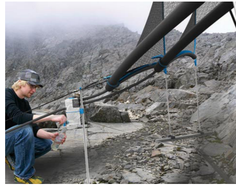
Figura 49. Recogida de agua en prototipo DropNet.
