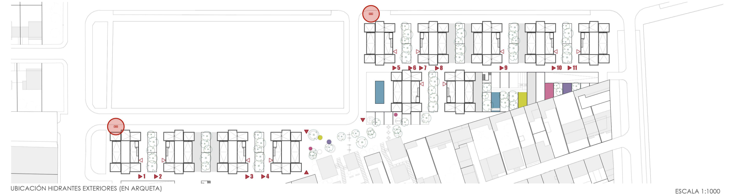
UBICACIÓN HIDRANTES EXTERIORES (EN ARQUETA)
