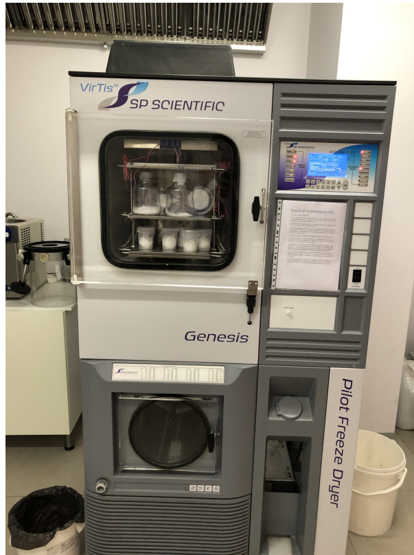
Figura 10: Equipo de liofilización en el edificio LUCIA, laboratorio de Bioforge.
