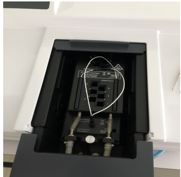
(b) Cámara con temperatura controlada para introducir las muestras a analizar.
