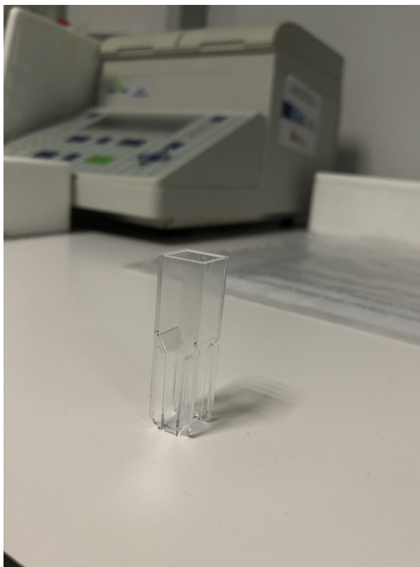
Figura 19: Cubeta en el que se introduce la muestra a analizar en el espectrofotómetro.
