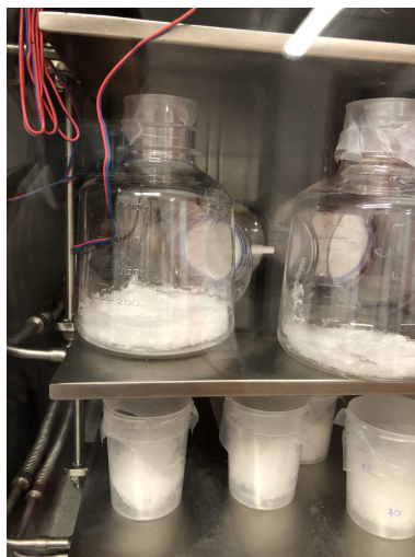
Figura 11: ELRs liofilizando. Se someten a un proceso de sublimación del agua para el secado del polímero.
