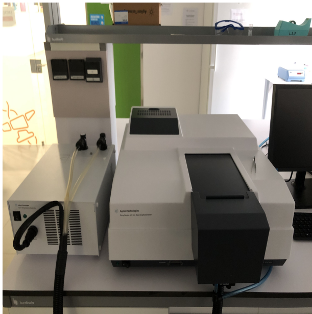
(a) Espectrofotómetro empleado para realizar mediciones de turbidimetría.
