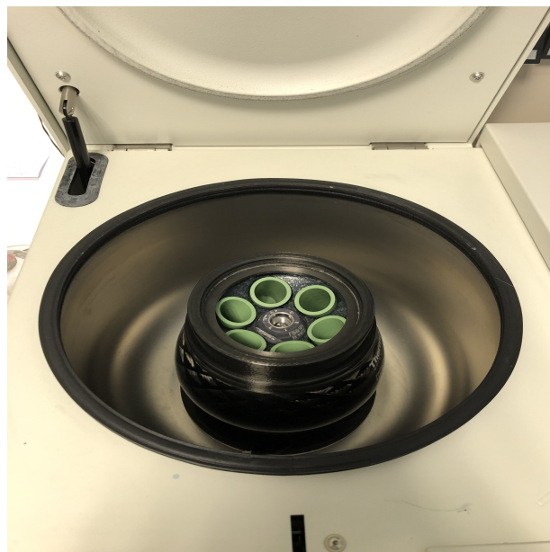
(b) Cámara donde se introducen los falcon con la disolución a centrifugar.
