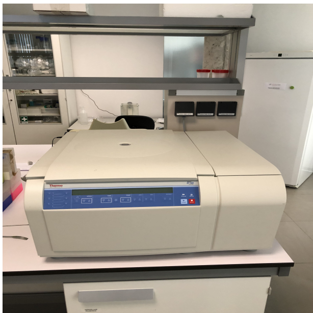
(a) Centrífuga. Muy útil para separar fases distintas de una misma disolución.
