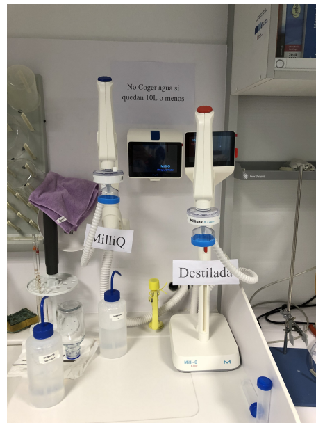
Figura 13: Equipo de obtención de agua ultrapura milliQ. Este agua carece de sustancias iónicas y otros compuestos. Se somete a procesos de ósmosis inversa, filtrados y desinfección.
