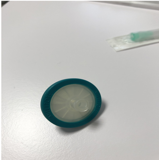
(a) Filtro de jeringa con microporos para eliminar impurezas de pequeño tamaño en una disolución.
