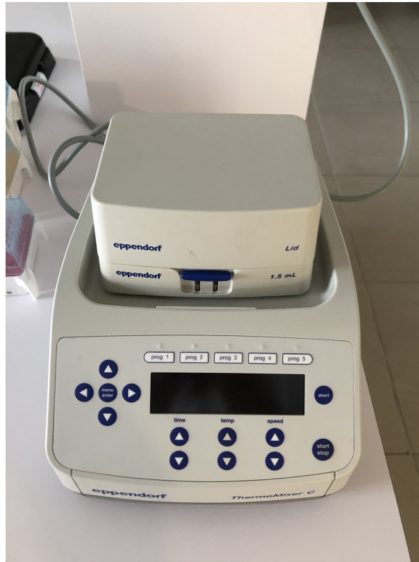
Figura 16: Termobloque. Empleado para realizar incubaciones con agitación y a temperatura fija.
