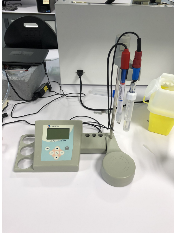
Figura 15: Medidor de pH. Dispone de un electrodo que se introduce en la disolución y mediante medidas de voltaje proporciona un valor de pH.
