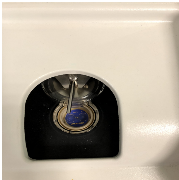
(b) Cámara en la que se introducen los crisoles con la muestra a analizar.
