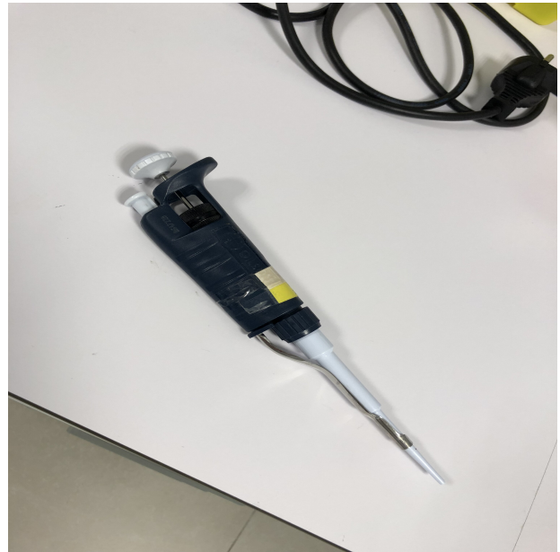
(b) Pipeta empleada en el laboratorio para el manejo de disoluciones. Permiten succionar un volumen determinado.
