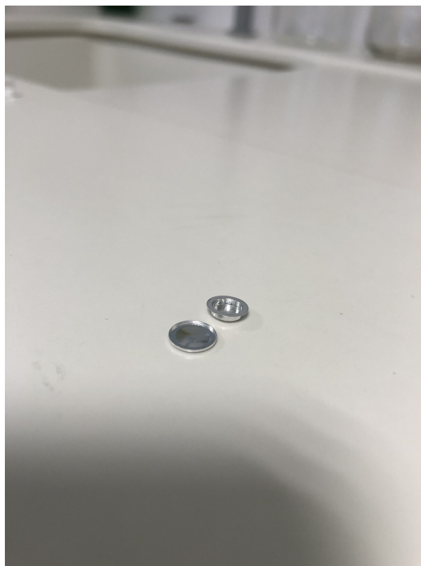
Figura 21: Crisol en el que se introducen 20 \mu\text{l} de muestra para realizar DSC. Dispone de una tapa para sellar la muestra.
