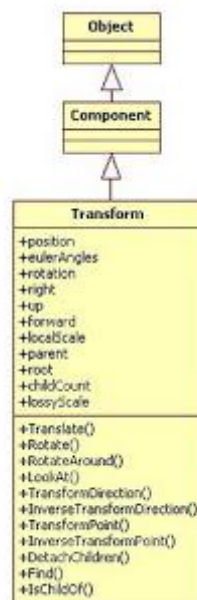
Figura 4.92 Diagrama de clases de la clase Transform
