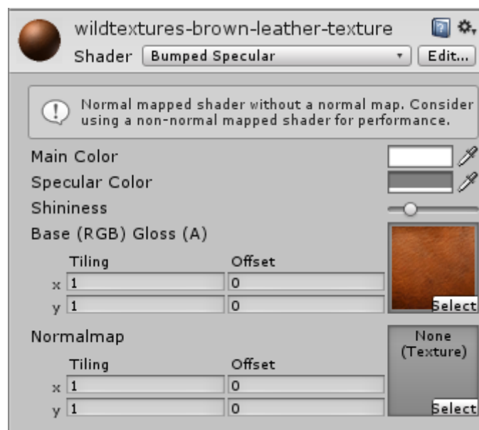
Figura 4.73 Propiedades del shader “Bumped Specular”
