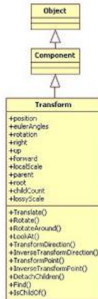
Figura 4.87 Diagrama de clases de la clase Transform
