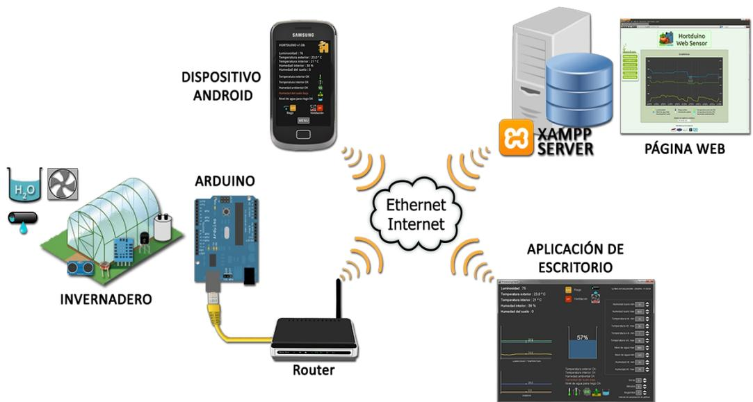
**Ilustración 12 – Despliegue del sistema Hortduino**
