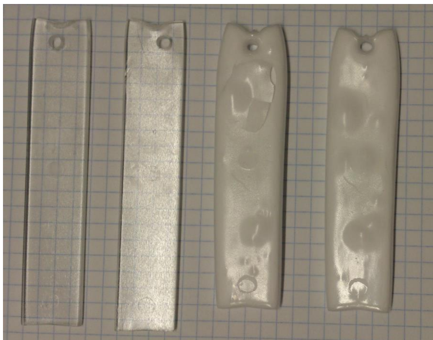
Figura 4.6.- Imagen comparativa de las muestras sin espumar (izquierda) y las muestras espumadas a una presión de 22.75 MPa y temperatura ambiente (derecha)
