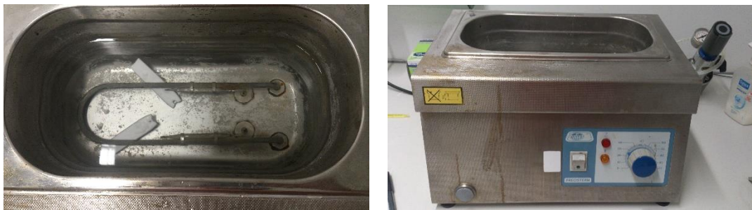
Figura 4.5.- Muestras espumadas en el interior del baño termostático (izquierda) y recipiente con control de temperatura del baño termostático (derecha).
