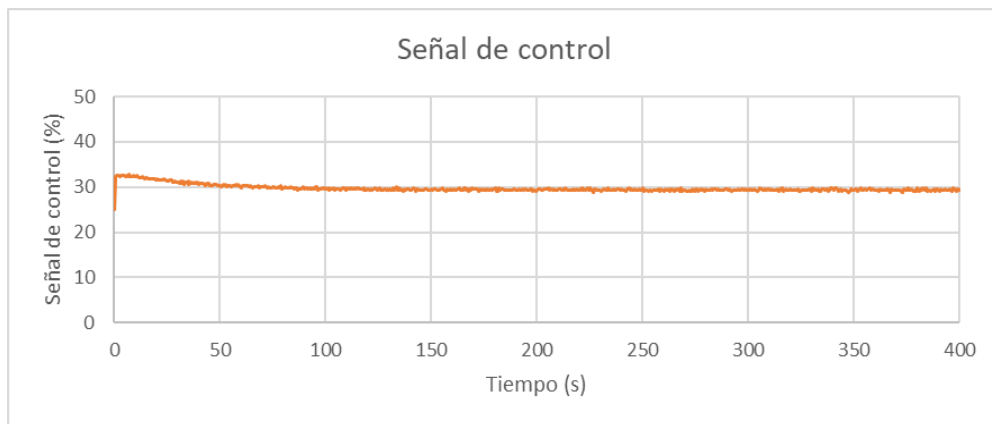
Figura 90 - Evolución señal de control ante salto en la referencia con controlador PI (Lambda Tuning)
