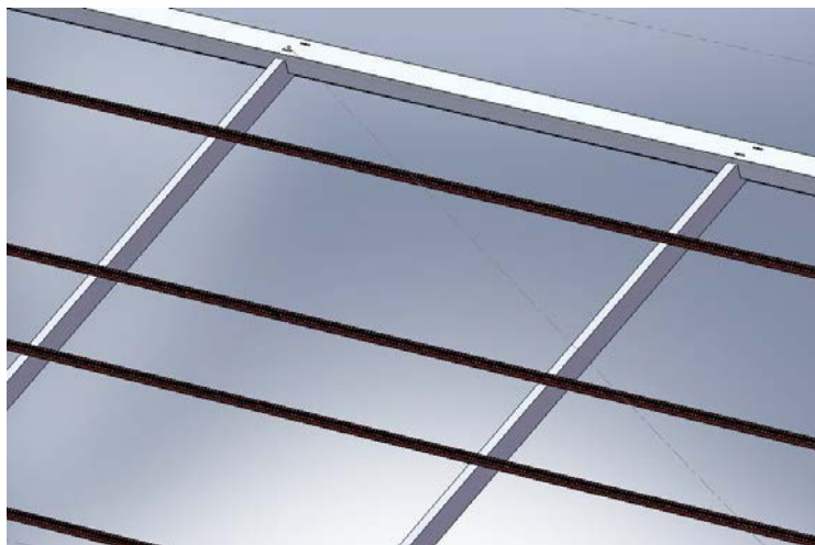
Figura 4. Detalle de la estructura con los carriles de unión.
