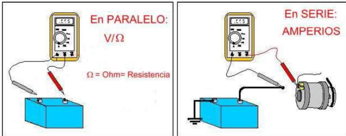
Además, existe otra diferencia a la hora de medir voltajes o intensidades. Para determinar el voltaje (también llamado caída de tensión o diferencia de potencial) entre dos puntos del circuito, el polímetro debe colocarse en paralelo con respecto a dichos puntos. En cambio, para medir la intensidad (o corriente) que circula por una rama del circuito, el polímetro debe situarse en serie con la misma. En la siguiente figura se esquematizan estos procedimientos.
