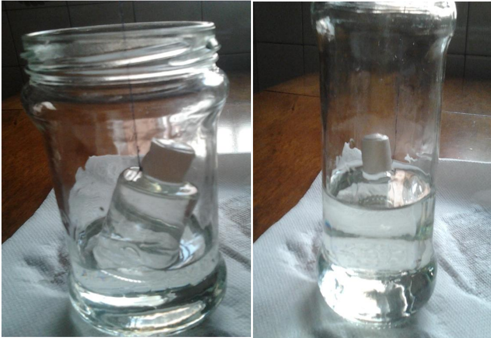
Figura 21: Bote relleno de glicerina antes y después de ser sumergido.
