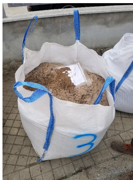
Fig. 41: Sustrato M2 compuesto por 25 % Compost + 75 % RCDs.
