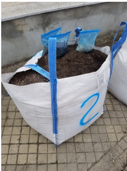
Fig. 42: Sustrato M3 compuesto por 75 % Compost + 25 % RCDs.
