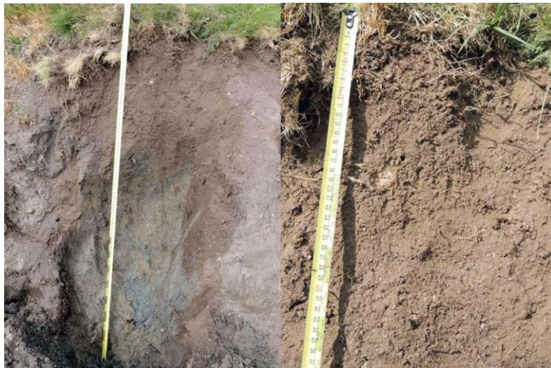
Figura 4. A) Vista de la calicata en la zona de nacimientos B) Vista del primer horizonte superficial A.
