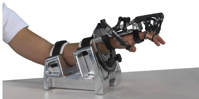
FIGURE 1. RobHand exoskeleton.
