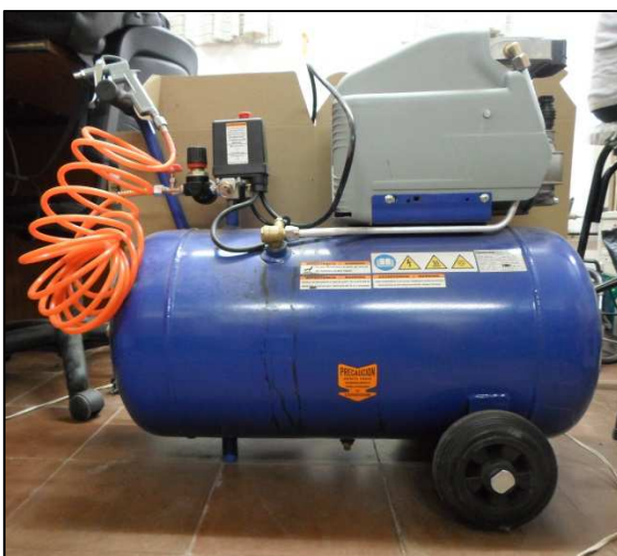
Fotografía 2: Compresor de aire utilizado para eliminar el serrín residual
