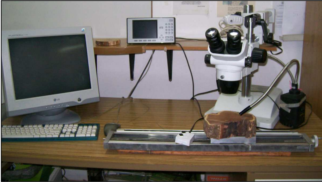
Fotografía 3: Equipo de medición Unislide TA 4020H1-S6 Velmex
