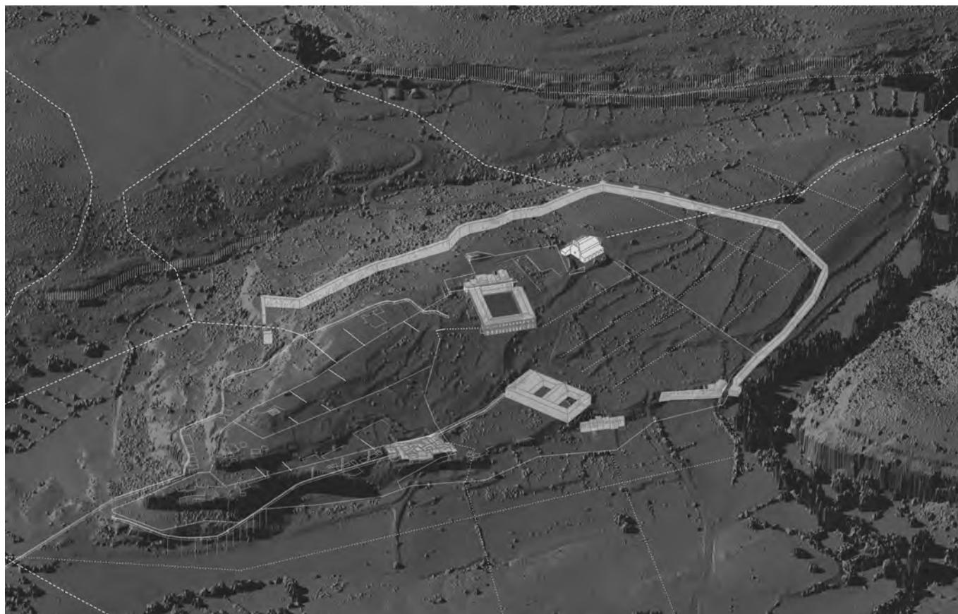
Fig. 26. Modelo tridimensional de Tiermes generado a partir del levantamiento láser LiDAR 2 x 2km paso de malla 1 m, 2017. Elaborado por C. Rodríguez. Fuente: Instituto Geográfico Nacional.
