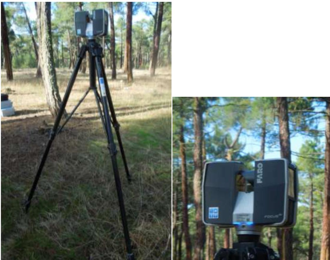
Imagen 4. Escáner Terrestre modelo *Faro Focus 3D*.
