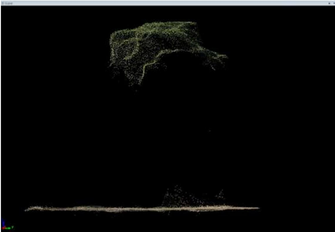
**Imagen 36.** Nube de puntos obtenida de un árbol a partir de fotogrametría.
