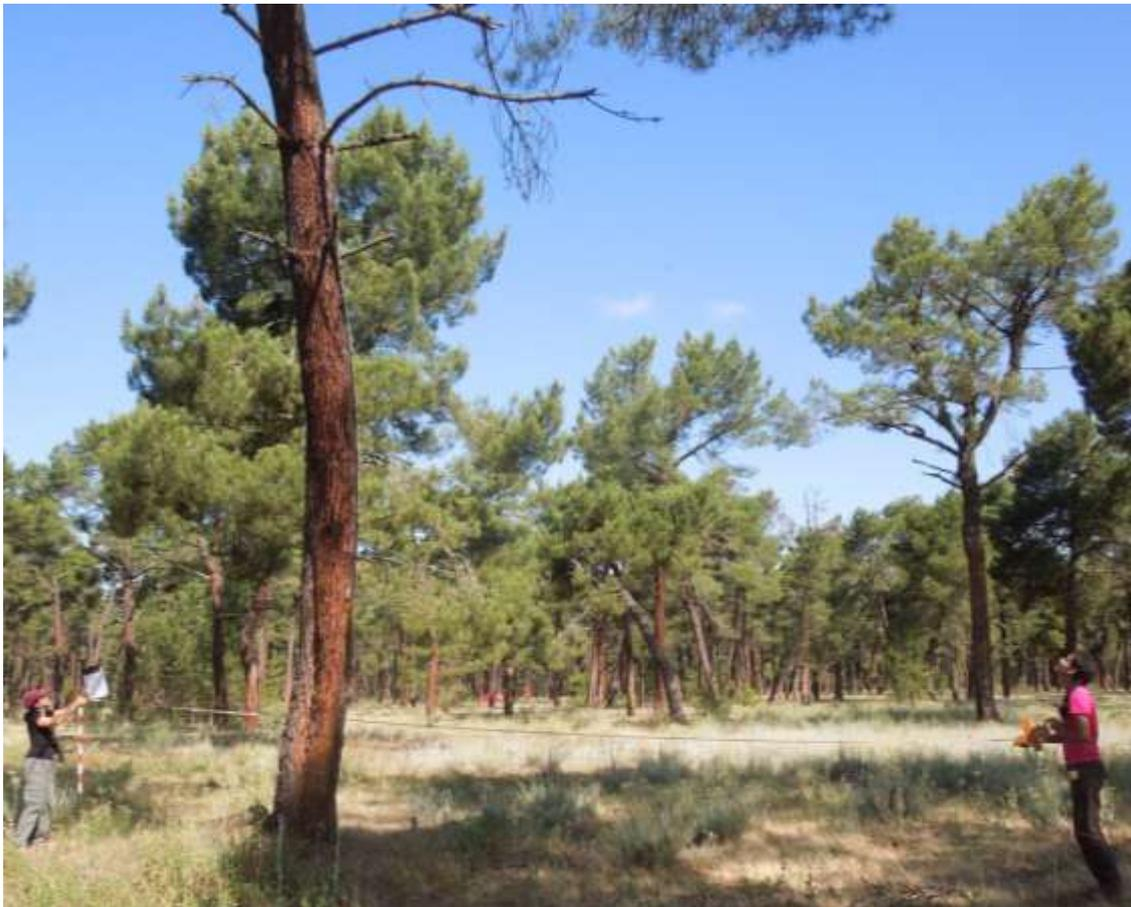
**Imagen 20.** Toma de datos de la anchura del diámetro de copa con cinta métrica.
