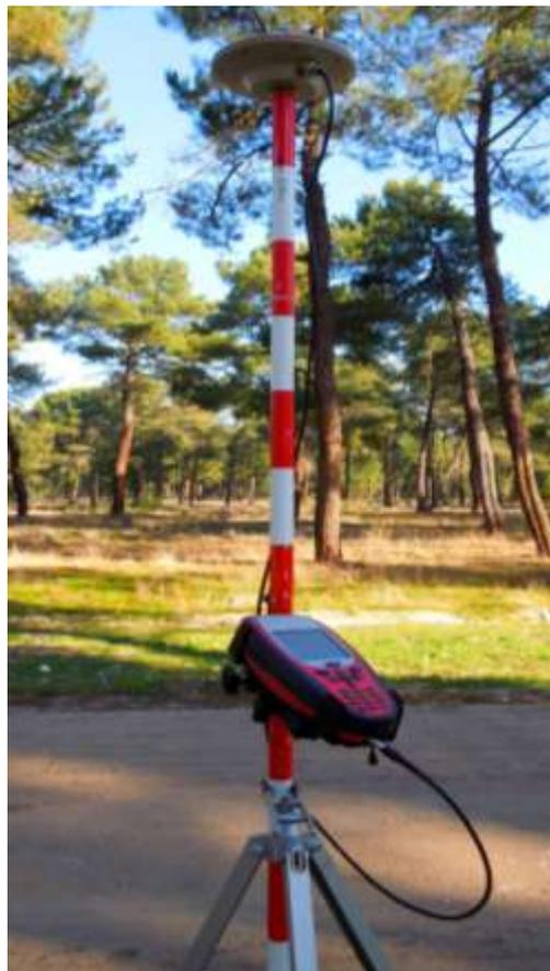
**Imagen 11.** GPS Leica modelo SR20 utilizado para conseguir las coordenadas submétricas del lugar de estudio.
