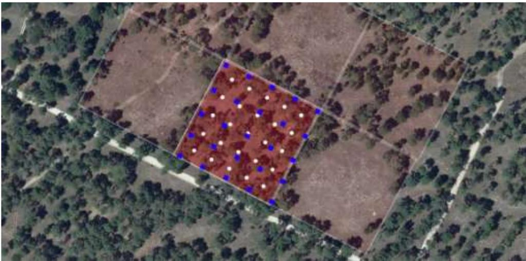
**Imagen 7.** Ejemplo de colocación de los barridos y los puntos de enlace llevado a cabo en cada parcela. Los puntos blancos representan las esferas y los cuadrados azules las posiciones de escaneo.
