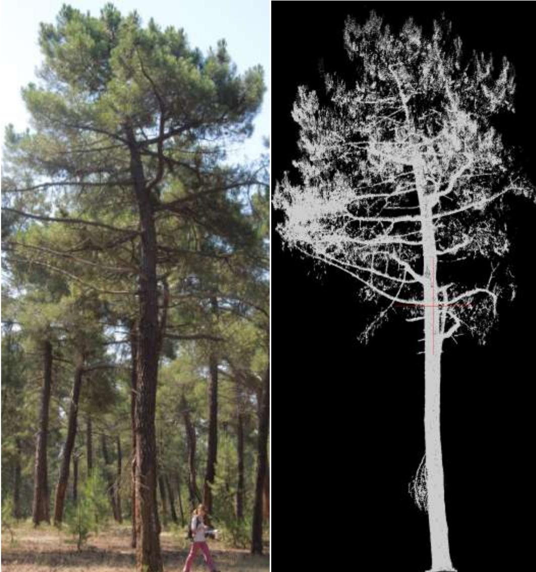
**Imagen 42.** La representación del árbol 11 de la parcela 2, en 3D a través de la tecnología LiDAR terrestre es muy precisa.
