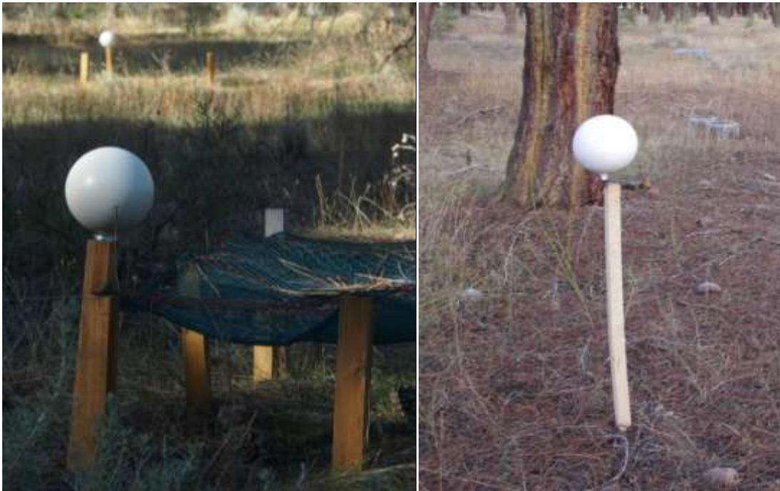
**Imagen 5.** Esferas blancas usadas para poder realizar la unión de los escaneos en gabinete. **Fotografía dcha.** Esferas originales del fabricante del escáner. **Fotografía izq.** Esferas blancas de elaboración propia.
