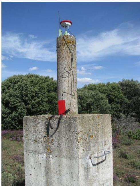
Figura 7. Vértice Geodésico de referencia ORDEÑO, y GPS-RTK
