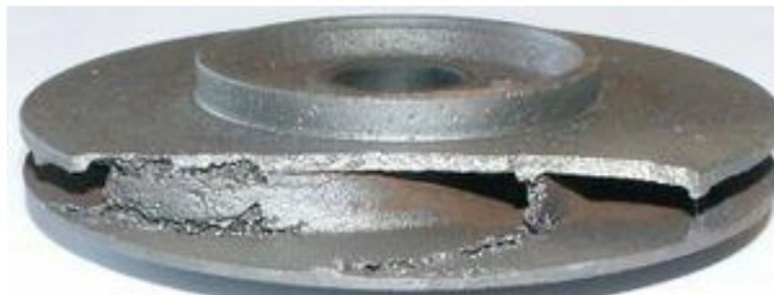
**Ilustración 7 - Rodete deteriorado por cavitación**
