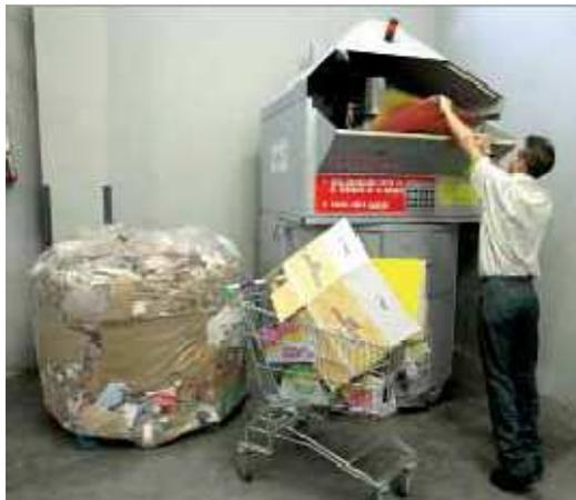
Figura 4. 2. Rotocompactora de cartón
