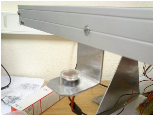
Ilustración 10: LDR que controla eje superior
