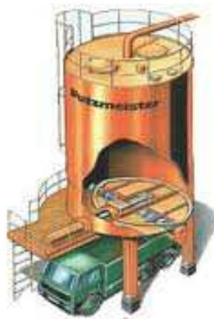
**Figura 6:** Silo de almacenamiento y carga de pellets en camión.
