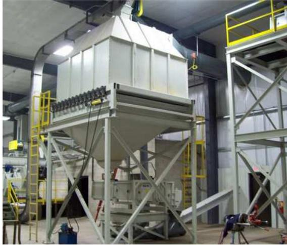
**Figura 5:** Sistema de enfriamiento de los pellets.
