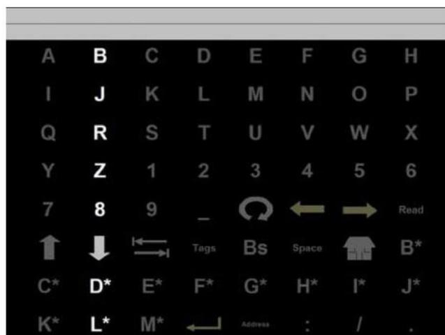
**Figura 2-22.** Matriz utilizada para provocar los potenciales evocados P300 en el navegador web desarrollado por Mugler *et al* [22].
