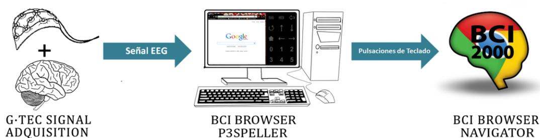
**Figura 4-1.** Estructura principal de la aplicación de navegación web desarrollada.
