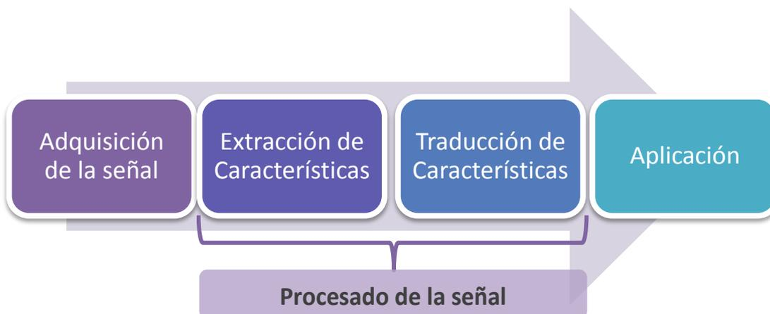
**Figura 2-11.** Etapas en las que se divide el tratamiento de la señal EEG: adquisición de la señal, procesamiento de la señal (extracción y traducción de características) y aplicación.
