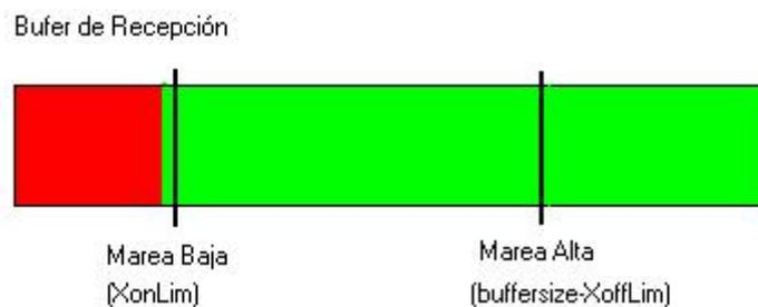
**Figura 2.3.** El buffer de recepción vaciado por debajo de la Marca de Marea Baja [B13].
