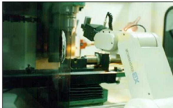
**Figura 3.18.** Imagen del Robot Mitsubishi abasteciendo a la Fresadora [W4].
