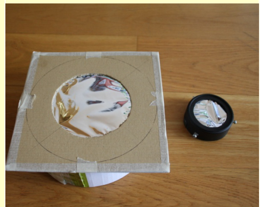
Fig. 4. Filtros de diferentes tamaños con lámina Baader caseros. (Fotografía de los autores).
