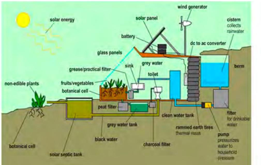
Figura 5. Prototipo de vivienda Earthship. El Muro de contención de tierra neumáticos permite una de las características más relevante del sistema: la ejecución de viviendas semienterradas que posibilitan el aprovechamiento de la inercia térmica del terreno natural. Foto Mike Reynolds.
