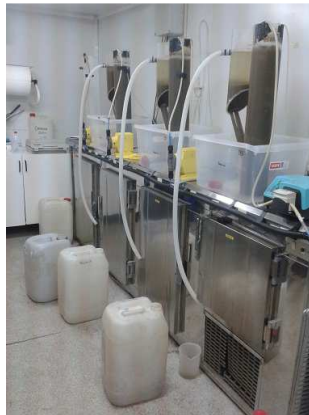
Figura 6. Segunda prueba con agua residual, fango activo y sistema de aireación air lift (fotografía tomada el 02/06/2014, a 4 días de la inoculación)
