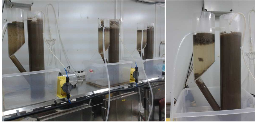
Figura 5. Primera prueba con agua residual urbana y fango activo, la figura de la derecha muestra la consistencia y flotación del fango.
