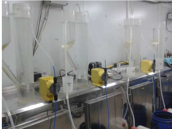
Figura 4. Prueba de calibración de bombas con agua potable y agitación
