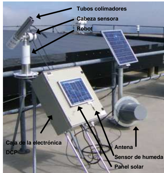
Figura 3: Fotómetro solar Cimel CE 318 y descripción de sus principales componentes
