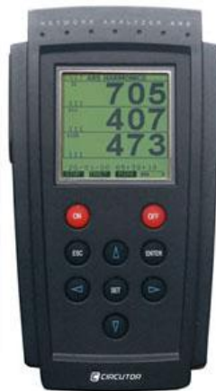
Figura 26. Analizador de redes utilizado
