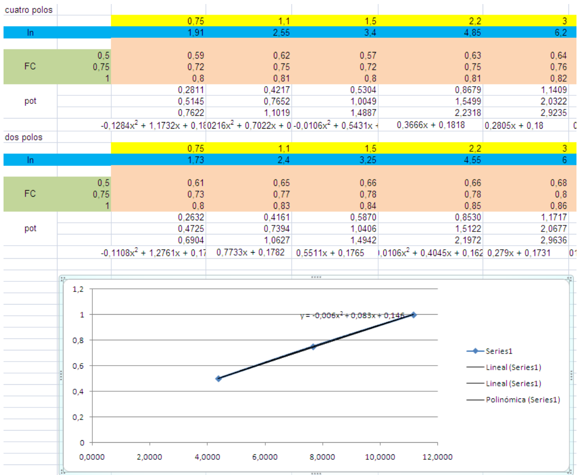
Figura 37. Cálculos para la obtención de las curvas del factor de potencia de cada motor
