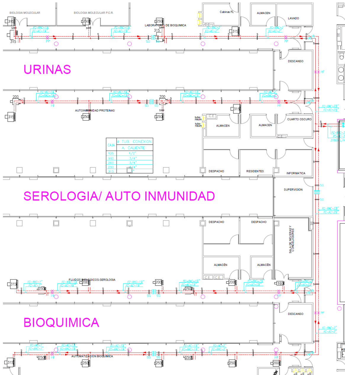
Figura 38. Instalación climatizadora de los laboratorios.
