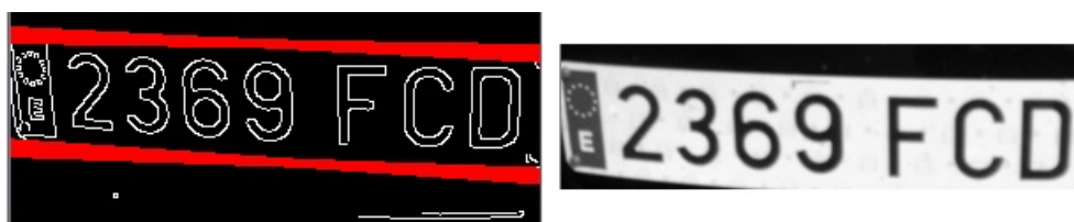
Figura 6.27. Corte con inclinación
