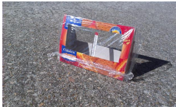
Figura 5: Material para comprobar el efecto invernadero.
