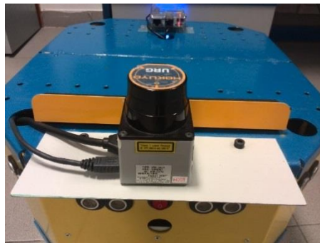
Figura 2.20. Sistema laser integrado en la plataforma robótica.
