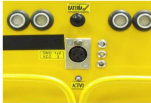
Figura 2.9. Detalle del sistema de carga.
