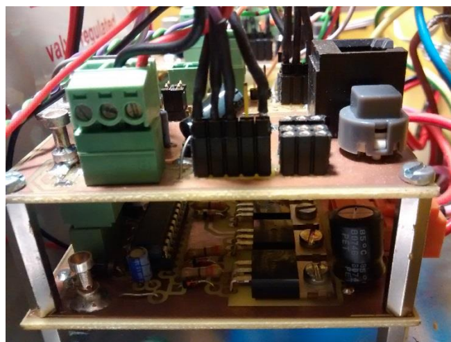
Figura 2.12. Placa controladora (arriba) y driver de motor (abajo).
