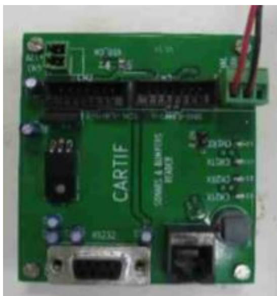
Figura 2.13. Placa concentradora de sonars y bumpers.
