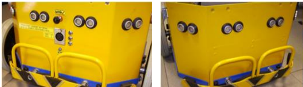
Figura 2.16. Colocación de los sensores ultrasónicos.
