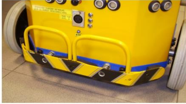
Figura 2.22. Bumper trasero en el robot Eusebio.
