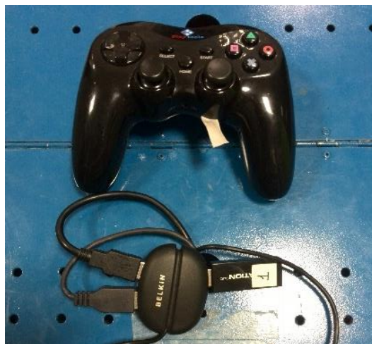
Figura 2.14. Mando y receptor para el control manual del robot.
