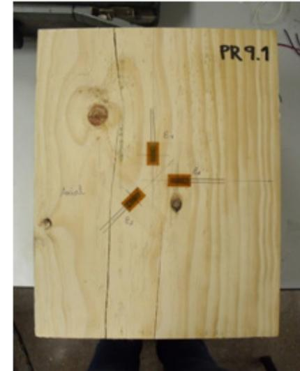
Figura 25. Probeta de laboratorio, antes de realizar el “hole drilling”. Fuente: Maite Crespo de Antonio
