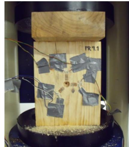
Figura 26 Probeta de laboratorio, después de realizar el “hole drilling”. Fuente: Maite Crespo de Antonio
