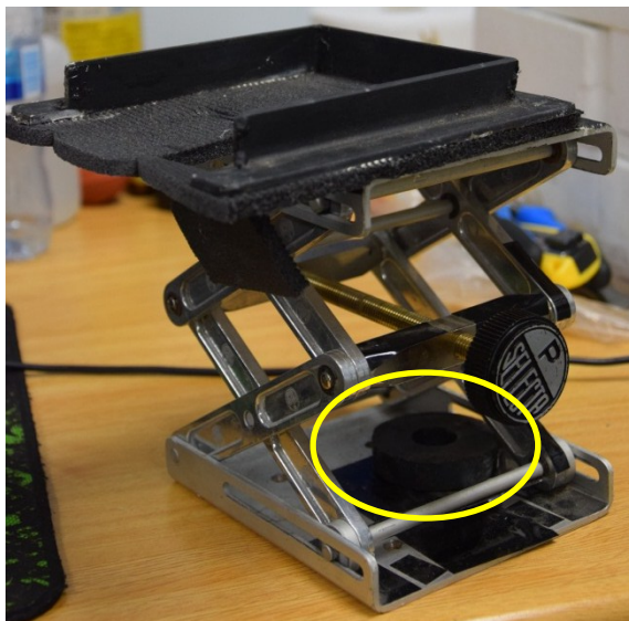
Figura 8.4.- Plataforma de la cámara unida al elevador. Señalado mediante un círculo amarillo está el imán utilizado para fijar la posición de la cámara (izquierda). Elevador LAB-ELE de JP Selecta utilizado.
