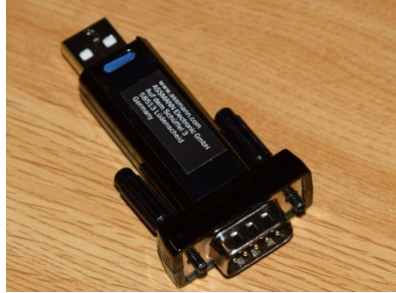
Figura 7.30.- Adaptador utilizado para el datalogger encargado del control de la temperatura de los láseres.
