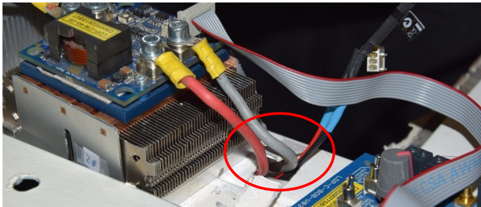
Figura 7.14.- Orificios efectuados en la tapa de la canaleta para la salida del cableado de alimentación de los drivers y del sistema de refrigeración de los láseres.
