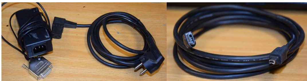
Figura 7.24.- Las dos partes del cable usado para la alimentación de la cámara (izquierda). Cable Firewire utilizado para la comunicación de la cámara con el ordenador (derecha).
