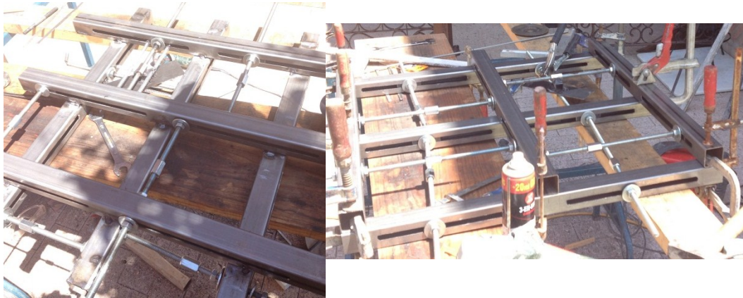
Figura 6.10.- Disposición con espacios de 180 x 180 mm (izquierda) y disposición con espacios de 300 x 300 mm (derecha).
