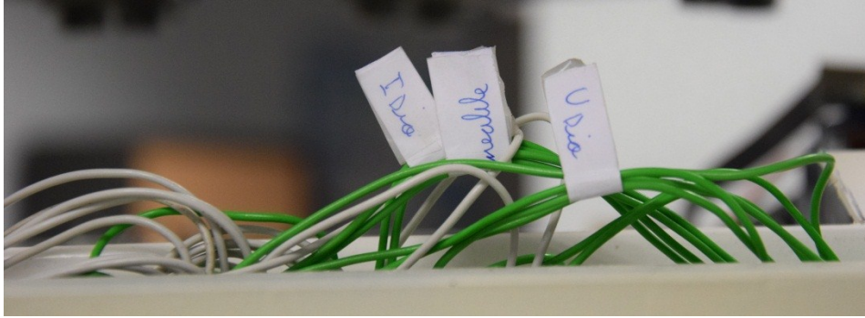
Figura 7.6.- Etiquetación de los cables de control y los colores utilizados para el sistema de control de los láseres de la parte trasera, el verde para el izquierdo y el blanco para el derecho.
