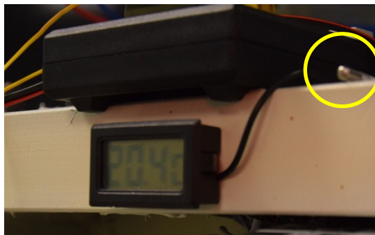
Figura 4.18. - Sistema de medida de la temperatura ambiente, señalado mediante un círculo amarillo el sensor.
