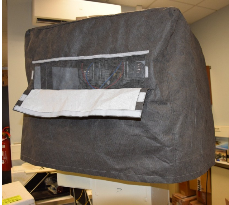
Figura 6.24.- Cubierta utilizada para prevenir la acumulación de polvo en los dispositivos electrónicos y los láseres y de prevención de incidencia de luz directa del exterior.
