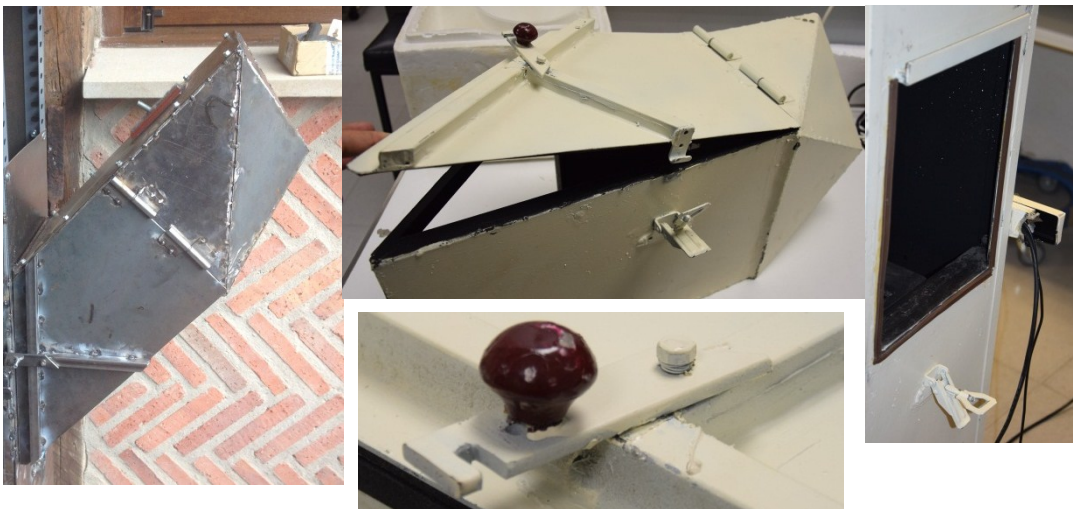
Figura 6.6. Armazón terminado para el sistema de captación por reflexión (derecha), puerta para el acceso a la cámara del sistema de captación por reflexión (arriba), detalle del vástago del cierre de la puerta (abajo) y sistema de sujeción del armazón de reflexión (izquierda).
