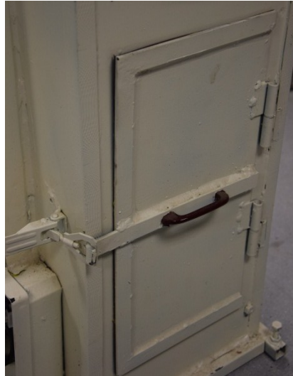
Figura 6.4.- Detalle de la puerta del armazón para la captación por transmisión, así como del sistema de cierre.
