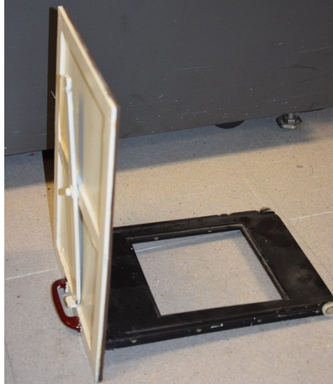
Figura 6.8.- Conjunto plataforma-puerta en el que consiste el sistema de apoyo de las células y las obleas.
