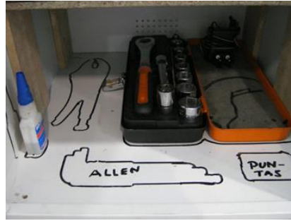
Figura 4.17. Siluetas de las herramientas del armario
