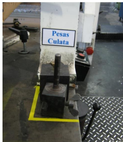
Figura 4.26. Delimitación de la ubicación de materiales en el suelo
