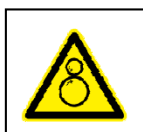
Imagen 52. Indicación de peligro por atrapamiento o aplastamiento. (Mejuto).
