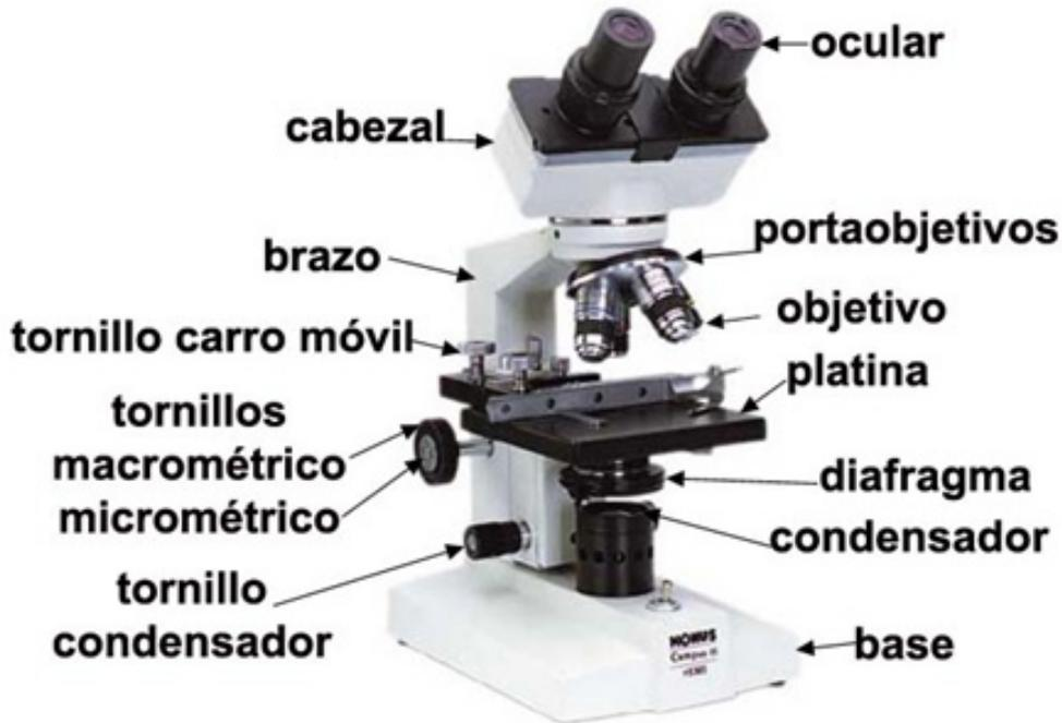
Fig.3. Esquema de las partes del microscopio óptico
