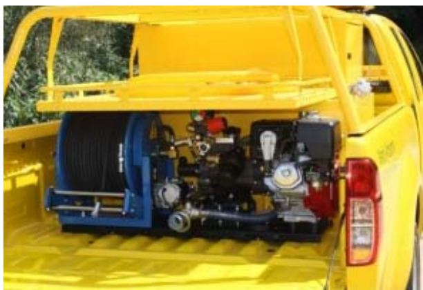
Figura 57. Kit de alta presión sobre un vehículo pick – up. Fuente. Vallfirest Imagen informativa
