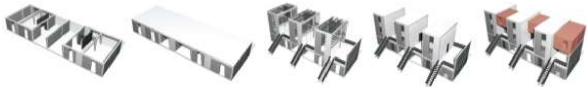
Figura 11: Proceso constructivo de la propuesta.
