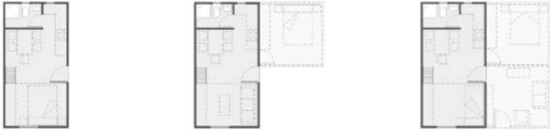
Figura 23: Distribución del módulo base, posibilidades de crecimiento.
