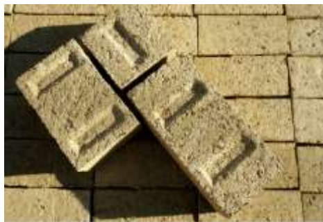
Figura 33: Bloque de BTC ligero, Cannabric, bloque entero, tres-cuartos y medio bloque.
