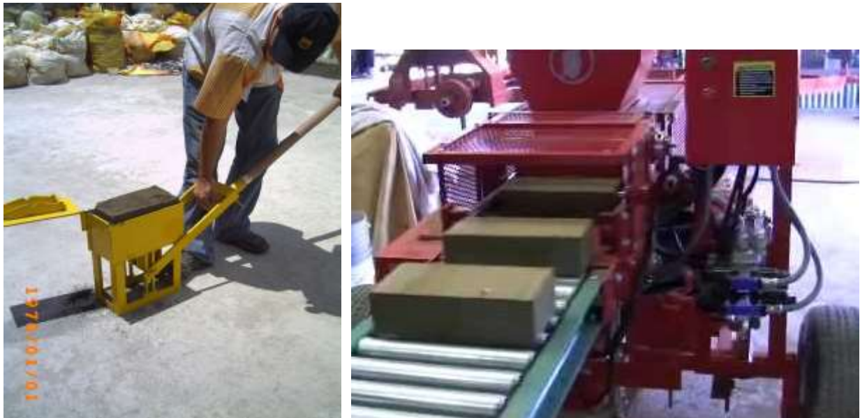
Figura 32: Prensa CINVARAM (izq.) y máquina de prensado industrializado (dcha.).
