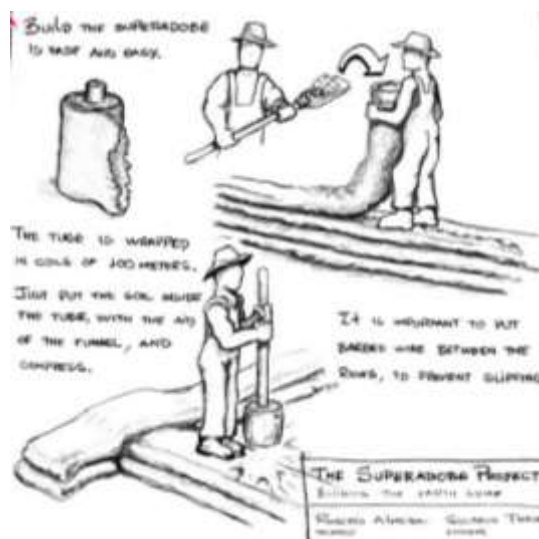
Figura 35: Croquis del proceso de construcción con superadobe (izq.) y ejemplo de construcción (dcha).
