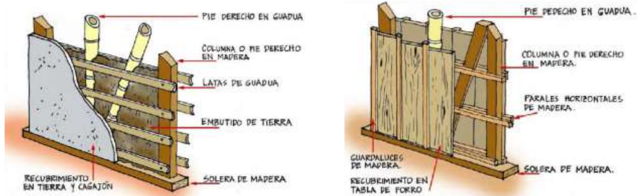
Figura 46: Bahareque embutido (izq.) y bahareque de tabla (dcha.).
