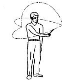
Figura 6. Trayectorias de barrido manual permitidas por la norma UNE EN ISO 16283-1
