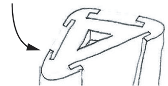
Sistema de encaje de piezas intermedias
