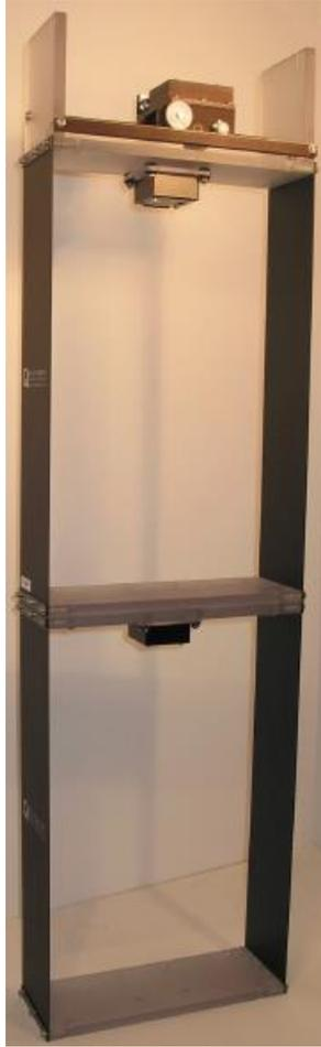
**Figura 2.4** Montaje de la estructura (fuente: Manual Quanser AMD-2)
