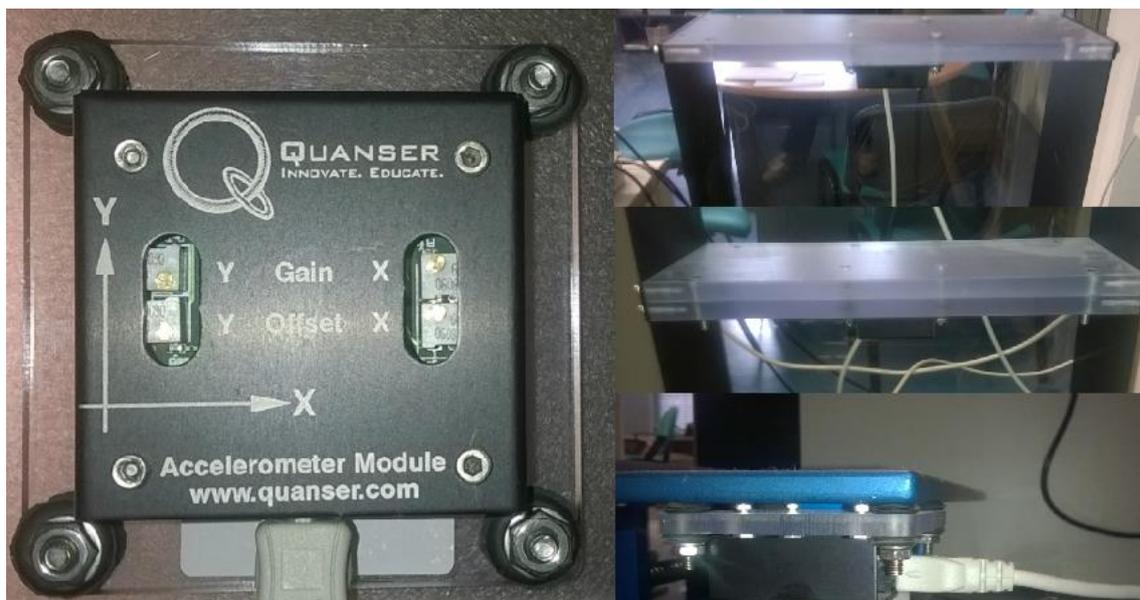
Figura 6.3 Detalle de acelerómetro y posición de los mismos
