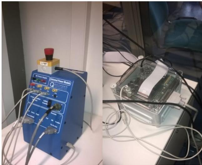
Figura 6.2 Módulo de potencia y tarjeta de adquisición de datos
